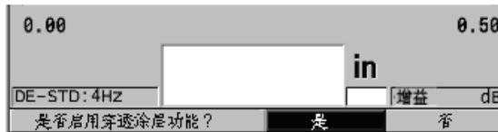
图 5-11 打开穿透涂层设置对话框
