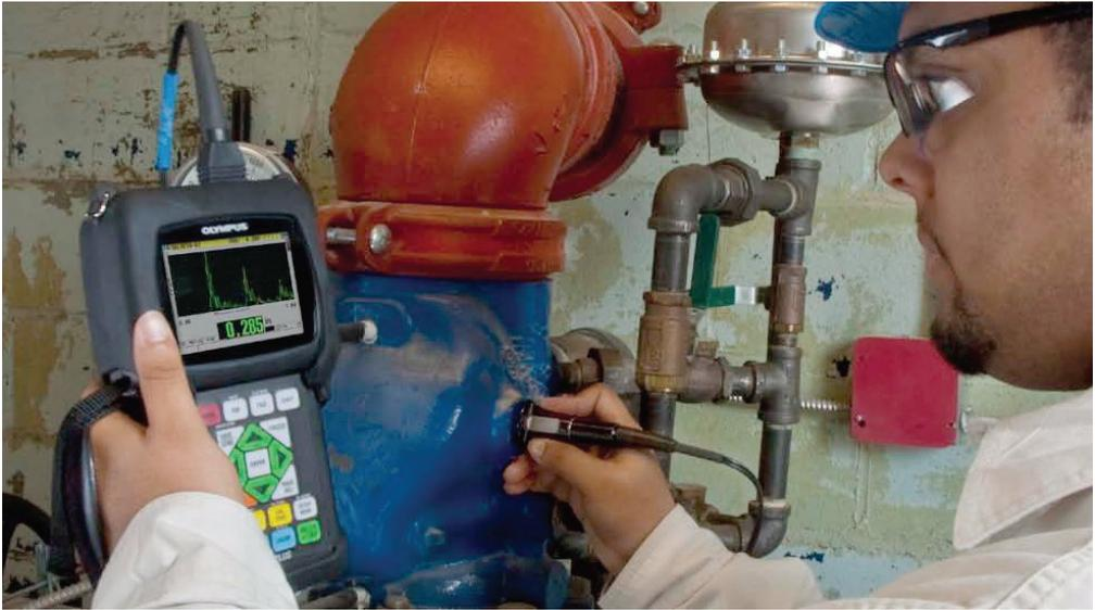
图 1-1 使用 38DL PLUS 仪器测量厚度
