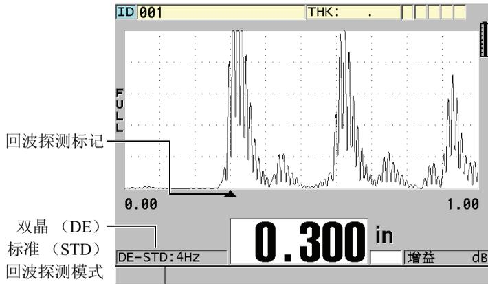
图 5-12 在标准回波探测模式下进行测量
