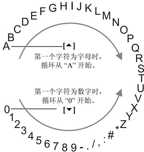
图 3-8 传统文本编辑方式的字符循环顺序
