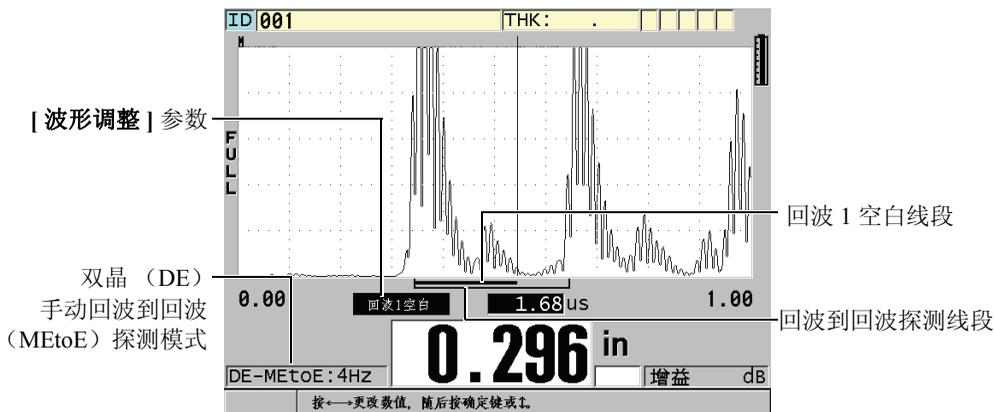
图 5-14 在手动回波到回波探测模式下进行测量
