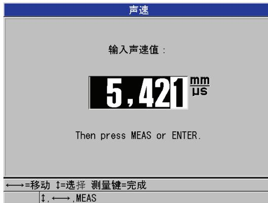
图 5-7 输入已知材料声速值
